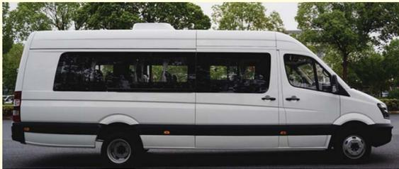
एक पटकको फुलचार्जमा ३ सय किलोमिटर गुड्ने यो बसमा ४ सय एनएमको टर्क र १ सय ४० किलोवाटको पिक् पावर रहने कम्पनीले बताएको छ। १ सय २३ किलोवाटको ब्याट्री जडान हुने यो बसमा पूर्ण रूपमा एयर कन्डिसन र सबैखाले सेफ्टी फिचर उपलब्ध हुनेछ, भने लम्बाइ २५ फिट हुनेछ। फराकिला सिट र पर्याप्त खाली ठाउँ हुने भएकाले लामो तथा छोटो दुरीमा सञ्चालन गर्न यो बस यात्रुमैत्री हुने शशिला मोटर्स प्रा.लि.का प्रबन्ध निर्देशक सन्तोष खतिवडाले बताएका छन्।
